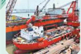
5月25日，三峽集團3,000噸全回轉起重船在位於江蘇的招商工業海門基地順利下水。該船是中國第一艘集遠海風電基礎運輸和起重施工為一體的專業化風電施工船機，並且滿足海洋工程施工作業的高行業標準，是一型多功能、高技術含量的海工起重船。該項目為自航吊船型，配置有八點錨泊定位系統和DP-2級動力定位系統。圖文：中新社
