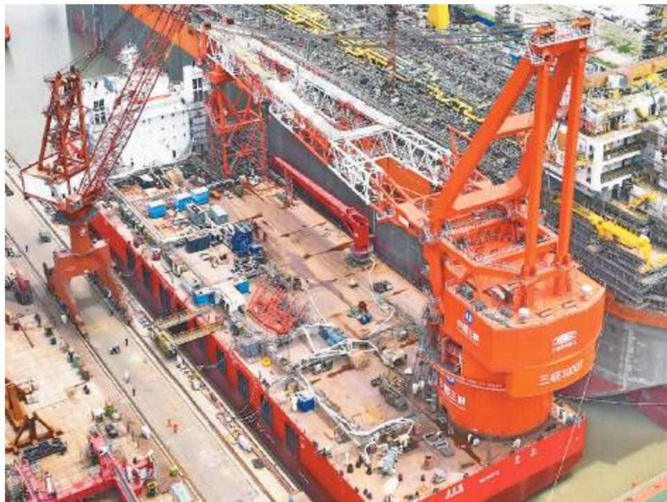
5月25日,在位于江苏省南通市海门区的招商工业海门基地,三峡集团3000吨全回转起重船顺利下水。该船是一艘集深远海风电基础运输和起重施工为一体的专业化风电施工船舶。该船建成后,主要用于10兆瓦及以上机组的桩基施工,可装载3600千焦等级打桩设备进行施工作业。 许丛军摄(人民视觉)
