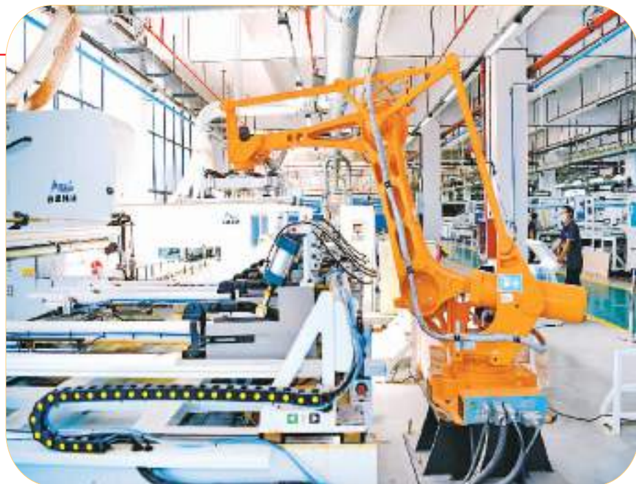
7月1日，江西省赣州市南康区家具零部件共享配料制作中心的工人在数字化生产线导入编程代码，遥控操作机械臂、传送带和数控切割机智能设备加工零件。 朱海鹏摄（人民视觉）
