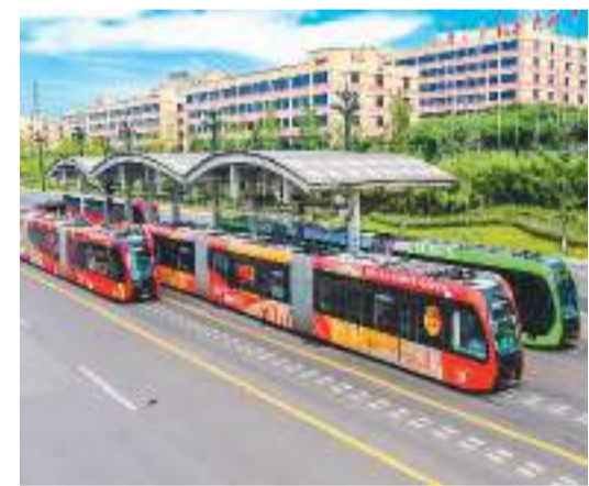
智轨电车由中国自主研发，不用钢轨和管线，车辆借助轨道跟随技术行驶，是一种新型绿色交通工具。图为在四川省宜宾市三江新区，智轨电车正在充电。 严易程摄(人民视觉)
