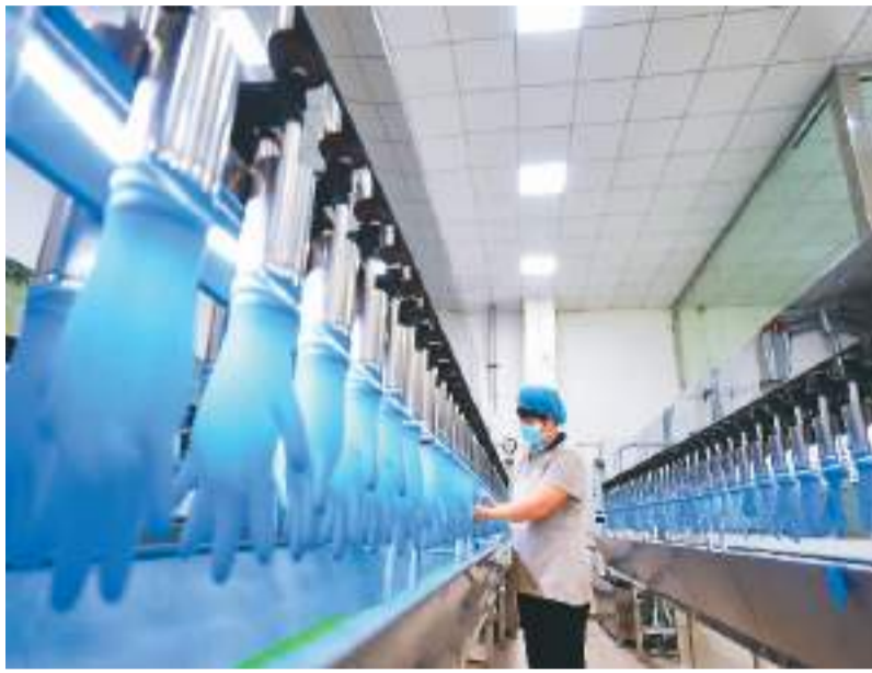
近年来，河北省南宮市引进高科技医疗用品企业，建成特种橡胶防护手套技术中心、高分子实验室和院士工作站，推进耐油、抗穿刺、不含过敏蛋白的丁腈手套的研发与生产。目前，南宮市年产丁腈手套60亿只，远销美国、日本、俄罗斯等60多个国家和地区。
