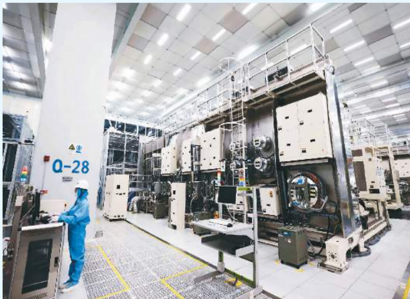
在安徽省合肥市新站高新区的合肥京东方显示技术有限公司的智能工厂内，依托于互联网的高新生产线有序运转，自动化设备精准地完成玻璃基板的传输、加工、检测等生产全过程。 琛琛摄（人民视觉）
