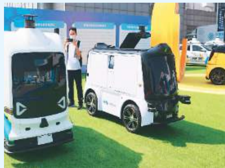
9月16日，在2022世界智能网联汽车大会上，参观者在拍摄展出的无人自动驾驶物流车。
