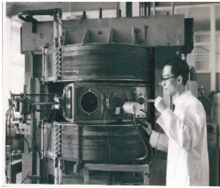
陈佳洱在进行扇形聚焦回旋加速器研究（一九六四年） 资料图片
