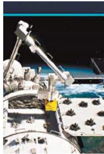
▲夢天實驗艙作為「工作室」，是三艙中支持載荷能力最強的艙段，其中配置了13個標準載荷機櫃，主要面向微重力科學研究，可支持流體物理、材料科學、超冷原子物理等前沿科學實驗項目。 資料圖片 ▲夢天艙載荷艙上配置有兩塊可在軌展開的暴露載荷實驗平台。 視頻截圖
