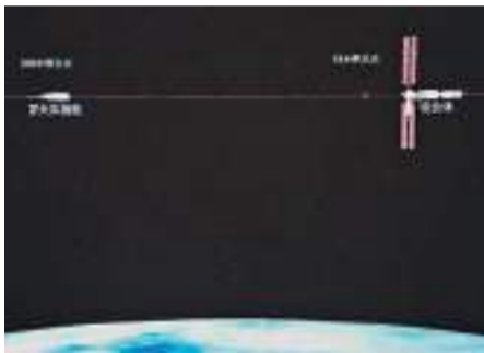
◆這是夢天實驗艙從200米停泊點向19米停泊點靠近的模擬圖像。 新華社
