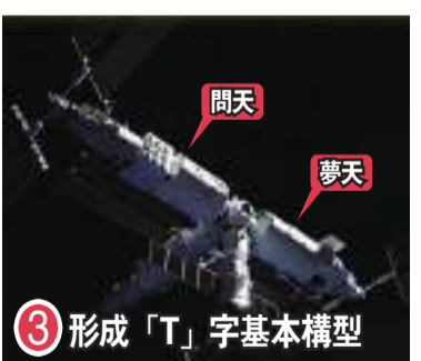
▲夢天實驗艙在前向對接口對接成功後，也隨即轉位到另一側停泊口，形成空間站「T」字基本構型。
