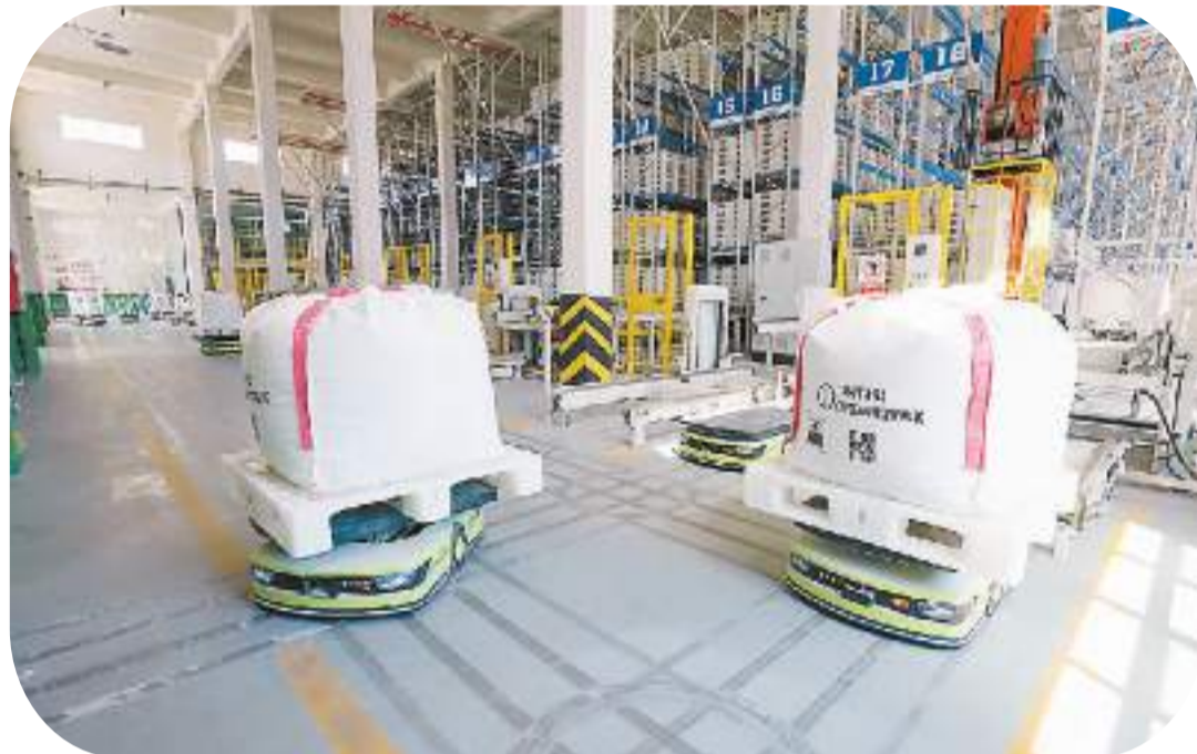
▲江西赣锋锂业股份有限公司依托云计算、AGV、大数据等先进制造技术，建设智能化仓储系统。图为不久前，万吨锂盐工厂智能立体仓库中，工业搬运机器人自动搬运物料。
