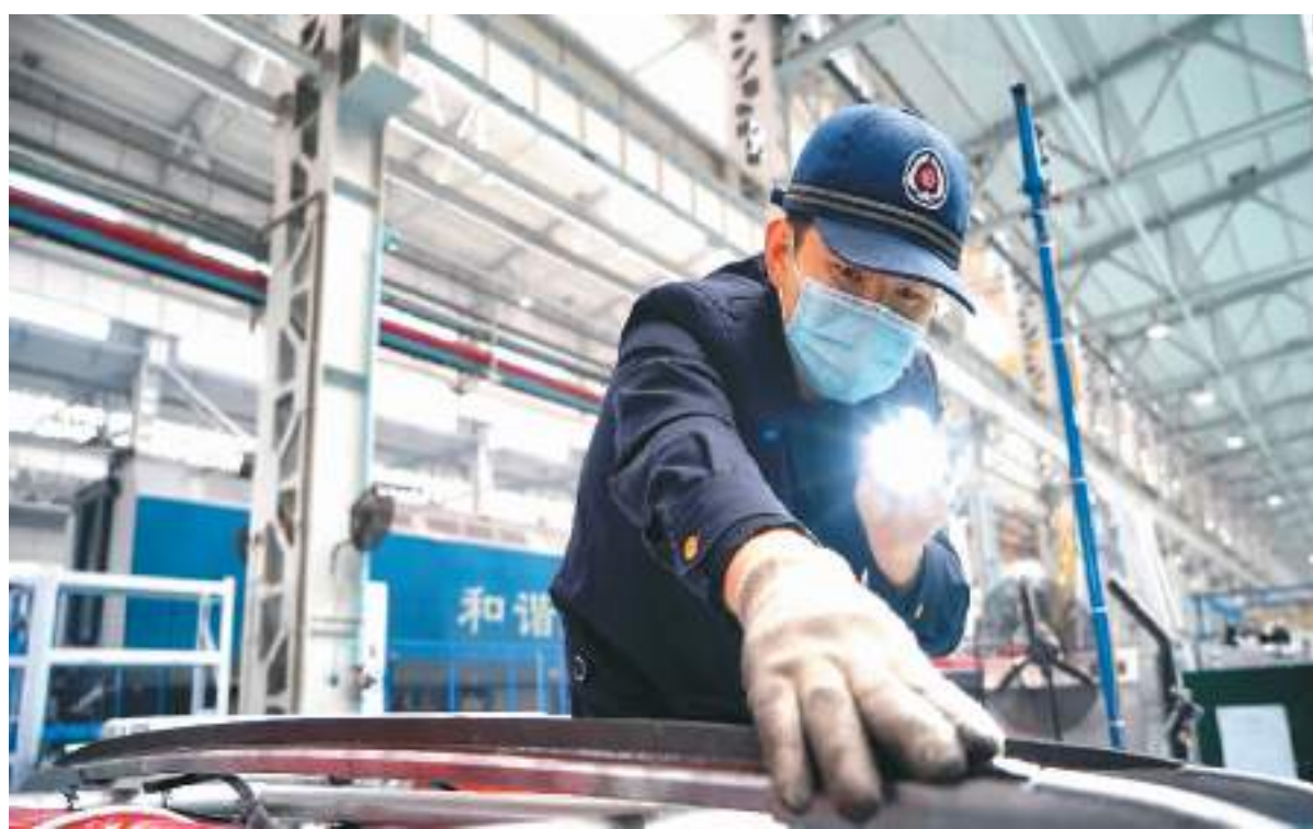
▲在成都机务段和谐型大功率机车检修基地，检修人员对和谐型机车的高压回路进行检修作业，为春运保驾护航。
