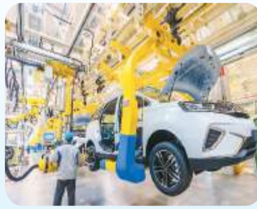
近日，在山西省运城市大运新能源汽车冲焊车间智能化生产流水线，智能焊接机械臂进行新能源汽车车架焊接作业。闫鑫摄（人民视觉）
