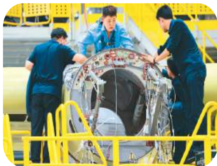
2022年11月7日，工程师在珠海中航通飞华南飞机工业有限公司AG600M总装线上进行发动机总装作业。
