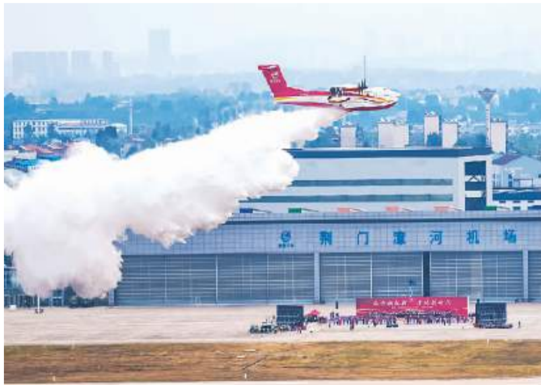
2022年9月27日，AG600M灭火机在湖北荆门漳河机场成功完成12吨级汲水试验。岳宇华摄
