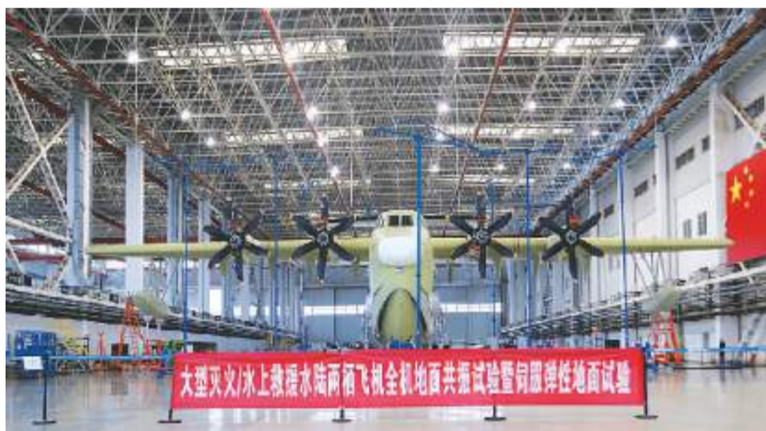
AG600M进行全机地面共振试验暨伺服弹性地面试验。谭宇强摄
