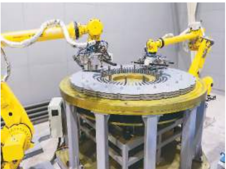
在哈电集团哈尔滨电机厂有限责任公司的生产车间，智能叠片机器人进行自动化作业。新华社记者 谢剑飞摄
