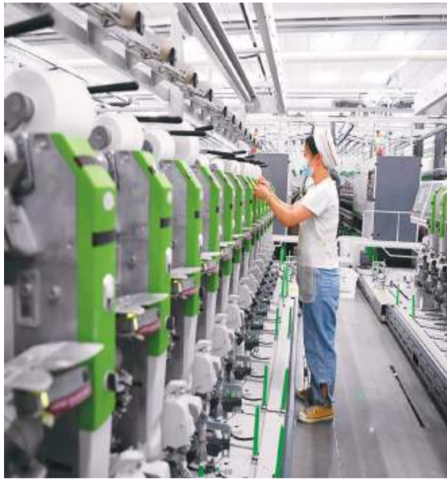
江西省宜春市奉新县积极引导纺织企业数字化转型，淘汰落后高能耗低效率生产设备，引进智能高效节能设备，助推纺织产业高质量发展。图为奉新县江西金源纺织有限公司的员工在全自动粗纱络联生产线上紧张忙碌。
