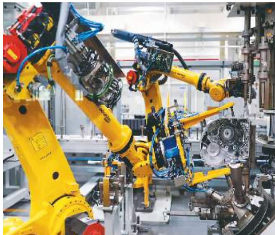
在安徽芜湖市繁昌经开区孚硕智能化生产线，智能机械臂进行新能源汽车自动变速器壳体压铸作业。 杨华摄（人民视觉）
