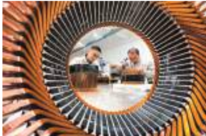
福建一家電機製造企業車間，員工組裝新開發的扁銅線發電機定子總成。
