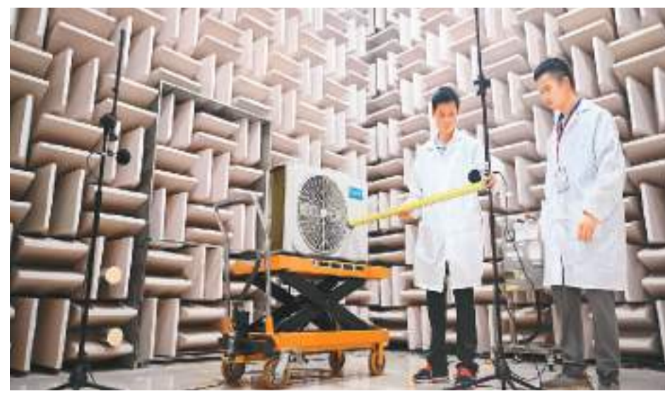
柳州市柳江区大力发展智能家电产业,目前已经引进智能家电企业29家,智能家电逐步成为柳江区规模以上工业经济增长的主力军。图为技术人员在柳江区一家空调企业的实验室里对即将上市的产品开展噪音测试。
