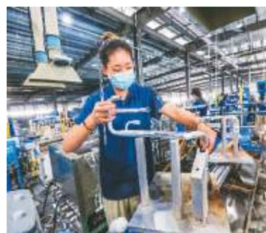
安徽省马鞍山市当涂县经开区抢抓长三角一体化发展重大机遇,加快发展新能源及高端装备制造产业,全面推进产业升级。图为经开区腾龙汽车零部件制造有限公司某项目自动化生产线上,工人赶制汽车空调弯管。
