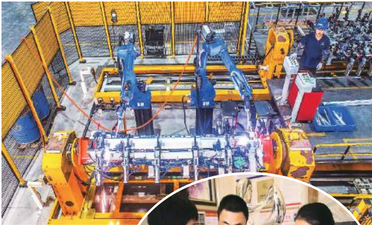
▲安徽马鞍山经开区近年大力推进制造业数字化智能化转型发展，推动集群制造业核心竞争力提升。图为马鞍山经开区一家企业数字化车间内，机器人在进行新能源汽车壳体拼焊作业。 王文生摄(人民视觉)
