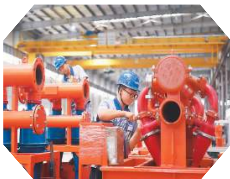
8月27日，河北省邢台市一家“小巨人”企业的工人在组装钻并泥浆环保处理装置。赵永辉摄（人民图片）
