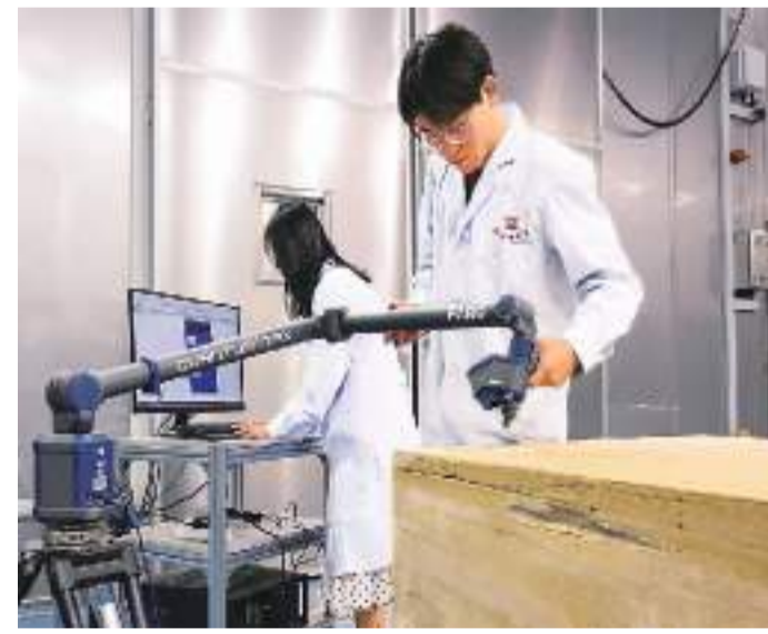
在甘肃敦煌研究院多场耦合实验室中，工作人员对庆阳北石窟寺砂岩样品进行三维扫描分析。 新华社记者 李贺摄
