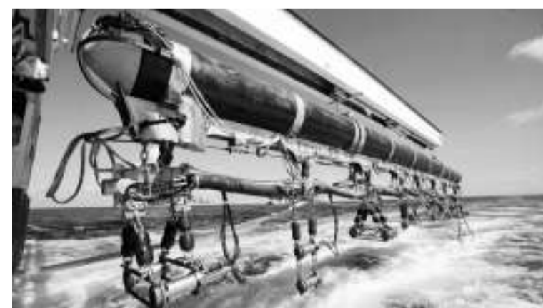
10月3日,中国自研海洋地震勘探装备“海经”首次实现超深水作业,图为“海经”震源控制系统入海。(中国海油供图)
