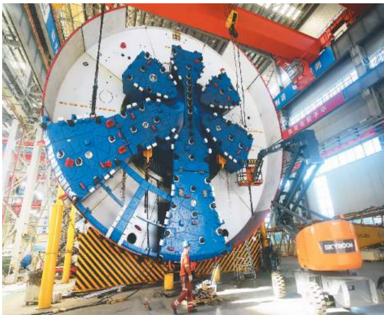
中铁“1398号”超大直径盾构机由浙江中铁路装备研发制造，是目前华东地区生产的最大直径泥水平衡盾构机，刀盘直径为15.4米，总重约4000吨，建成后将于上海崇太（崇明岛—太仓）过江隧道工程项目。图为近日，在位于浙江杭州的中铁路装备盾构机生产基地，工人正在生产组装中铁“1398号”超大直径盾构机。龙 巍 摄
