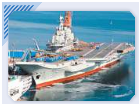
◆中國第三艘航空母艦福建艦在央視《新聞聯播》中出鏡。相比2022年福建艦下水畫面，其電磁彈射裝置上的施工棚已經拆除，三條彈射軌道清晰可見。 視頻截圖
