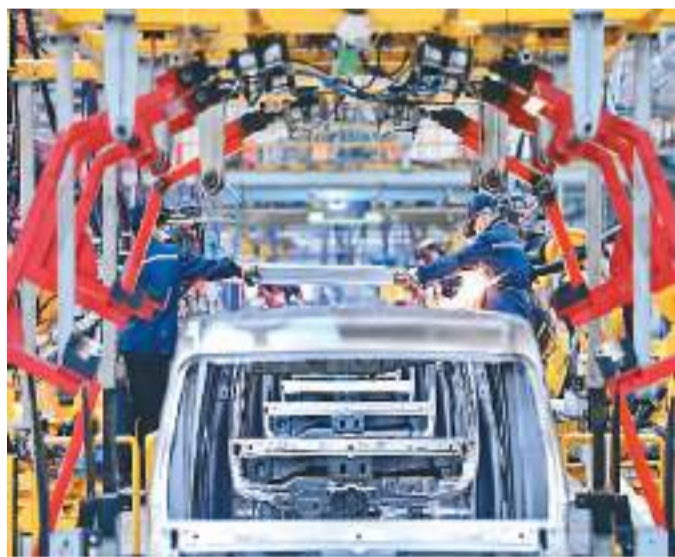
江西省赣州市经济技术开发区一家新能源汽车制造公司车间内，员工在焊接组装出口南美国家的新能源电动汽车。
