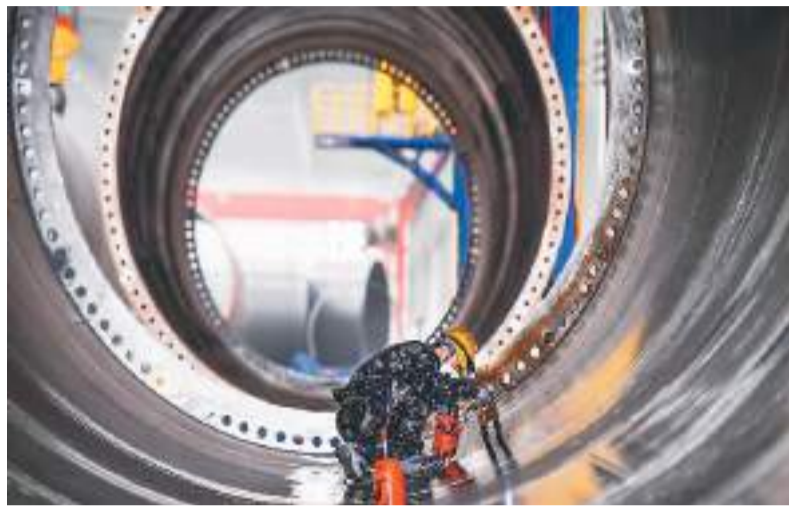
江西省宜春市袁州区积极提供产业、金融等政策指引和专项服务,促进各类中小企业做大做强。图为袁州区锦峰重工科技有限公司的工人在检测风电塔筒的焊缝质量。周亮摄(人民视觉)
