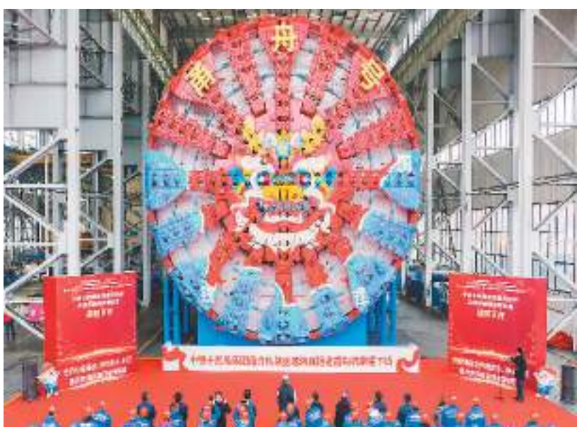
2月26日, 由中铁十四局集团、铁建重工集团联合研发的超大大直径盾构机“甬舟号”在湖南长沙下线。“甬舟号”全长135米, 刀盘开挖直径14.57米, 将应用于世界上最长海底高铁隧道——甬舟铁路金塘海底隧道建设。图为“甬舟号”下线仪式现场。 李 健 摄 (人民视觉)
