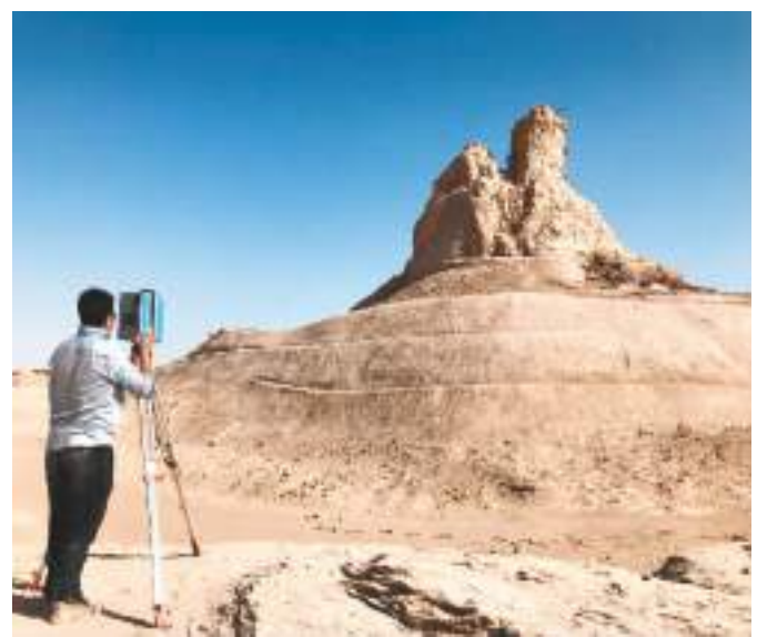
▲技术人员用三维激光扫描技术为楼兰故城佛塔遗址建立数字化档案。 中铁西北科学研究院有限公司供图
