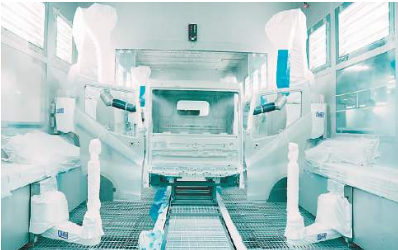
▲江苏省淮安市比亚迪卡车智慧工厂的自动涂装生产线。
